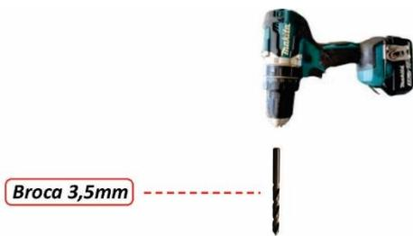
*Fure a chapa de fixação dos finger's com broca de Ø 3,5mm para instalar os conectores Sindal.*
