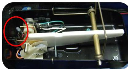
1 resistor 220 OHMS no pedal do acelerador(3)
